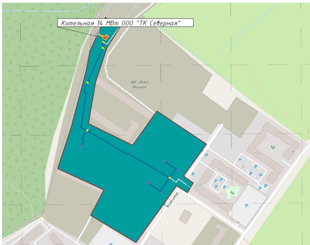
**Рисунок 12. Зона действия и тепловые сети котельной 14 МВт ООО «Тепловая Компания Северная»**
