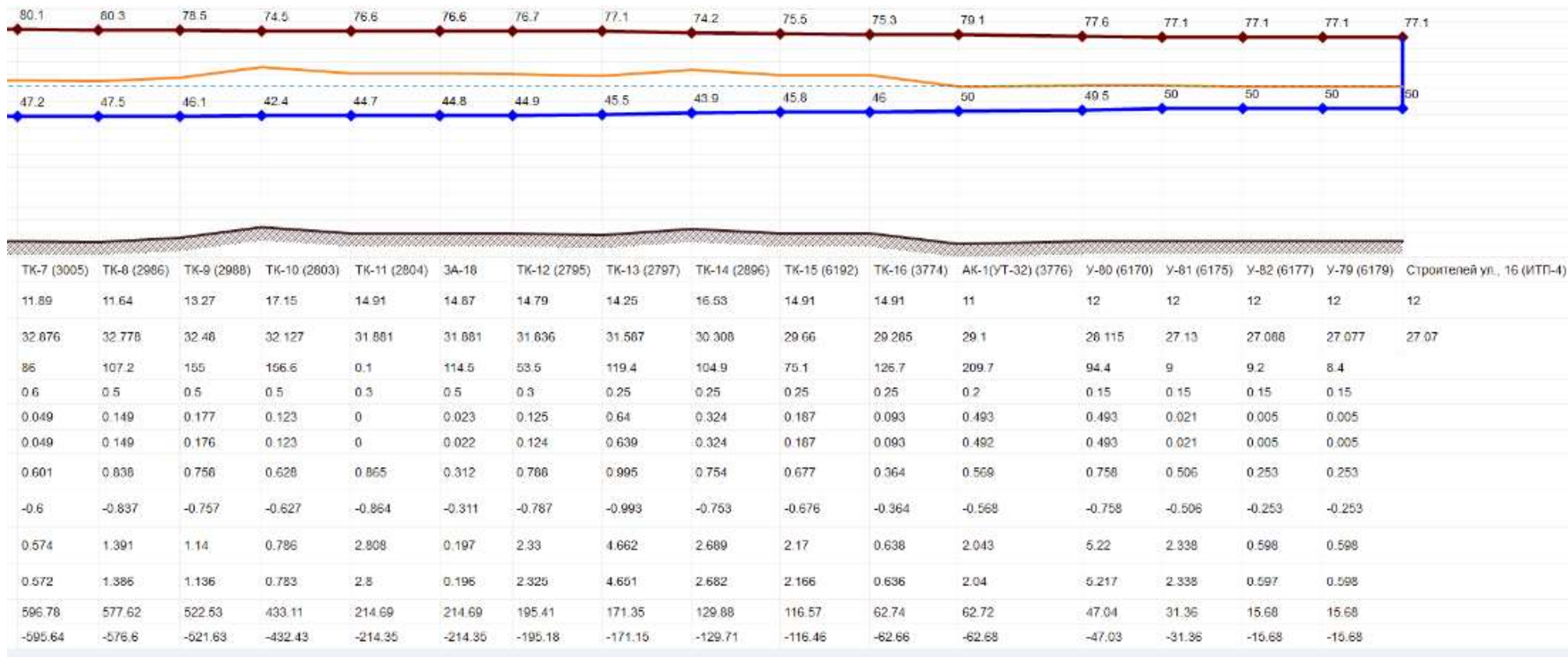
Рисунок 34. Пьезометрический график от Правобережной ТЭЦ-5(часть 2)
