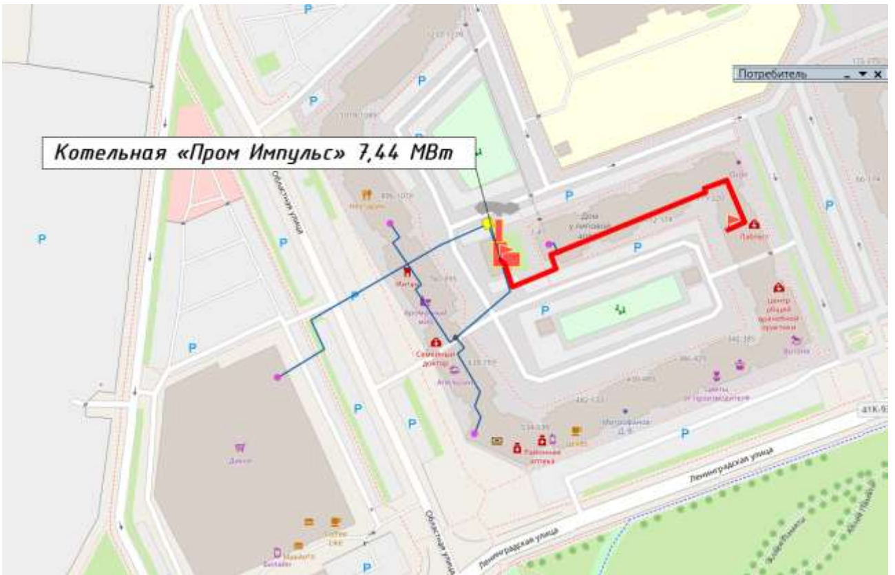
Рисунок 45. Путь построения пьезометрического графика от котельной 7,44 МВт
